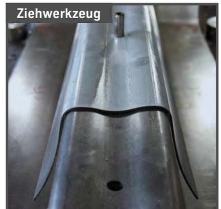
④ Aufbau des Ziehwerkzeugs (links), vorgezogene U-Schale ohne Schweißflansch (rechts)
