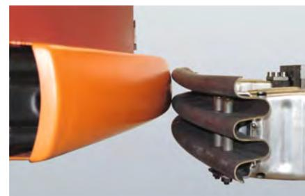
❸ Ergebnisse der Crashtestsimulation RCAR Bumper Test, Schnitt mit Grenzebene und Versuchsaufbau
