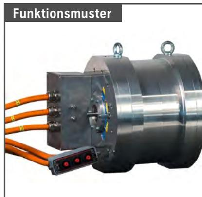
8 Blechpakete inklusive Wicklung am Stator (links) sowie funktionsbereite E-Maschine (rechts)
