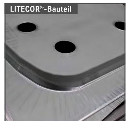
③ Vergleich von Simulation (links) und Bauteil (rechts) an einer umformkritischen Stelle
