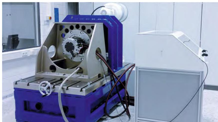
③ Motorenprüfstand im neuen E-Mobility Center Drives bei ThyssenKrupp in Bochum
