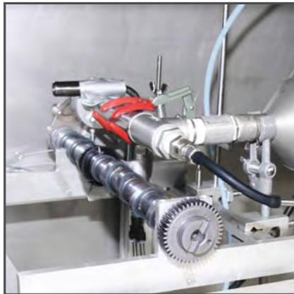
intensiv untersucht. Auf ihm wird das Ölablaufverhalten mit einem transparenten Nockenwellen-Dummy und verschiedenen transparenten Varianten des Reingaskanals visualisiert. Besondere Aufmerksamkeit erfahren dabei strömungskritische Bereiche wie die Schnittstelle von Reingaskanal und Nockenwellenrohr, die Innengeometrie des Kanals sowie der Ölablauf.
