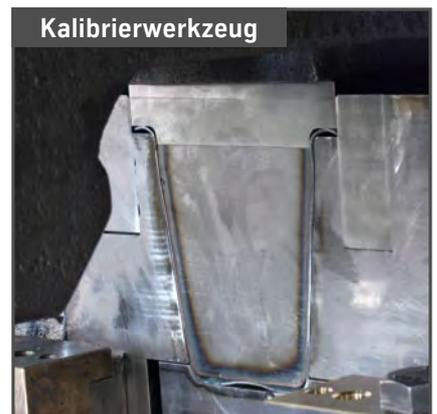
⑤ Aufbau des Kalibrierwerkzeugs (links), Kalibrieren der U-Schale mit Schweißflansch (rechts)
