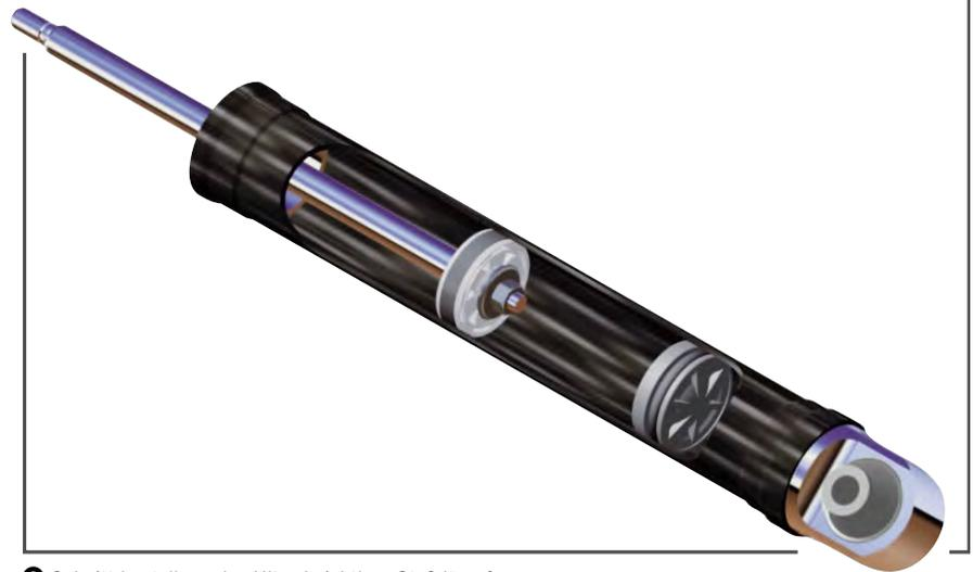
9 Schnittdarstellung des Ultra-Leichtbau-Stoßdämpfers
