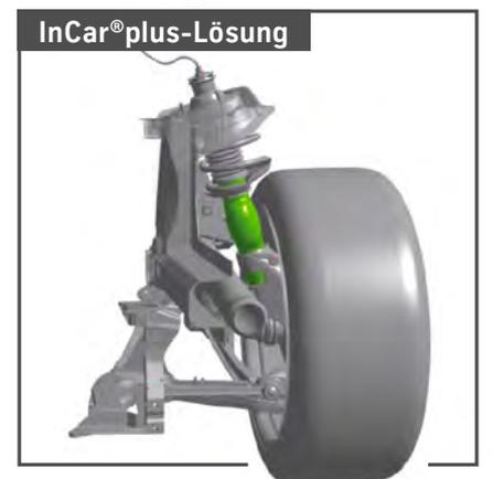
❷ Schematischer Einbau des Referenz-Dämpferrohrs (links) und des T<sup>3</sup>-Dämpferrohrs (rechts)
