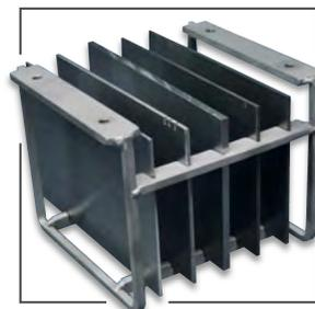
❶ Test des Heißgaskorrosionsverhaltens in der Diesel-Abgaskammer (links) und Halterung für die Werkstoffproben (rechts)
