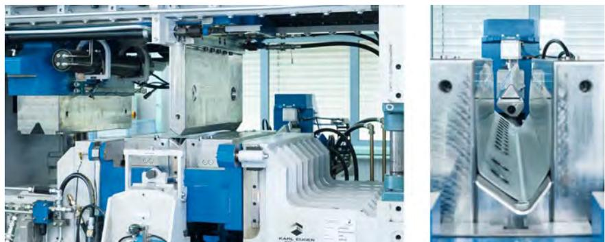
3 T<sup>3</sup>-Pressenadapter: aufsprungfreies Halten der U-Schale durch verdrängbare Wände
