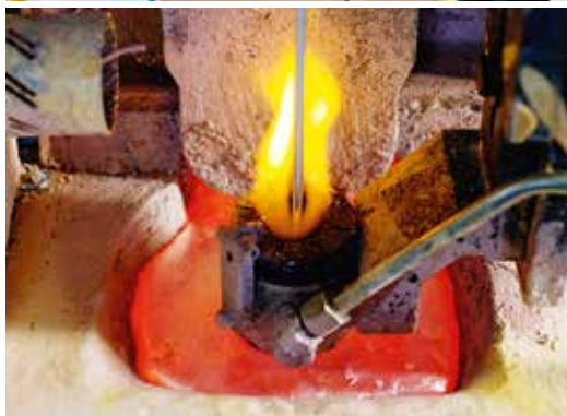
Rollenverteilung: Kupferbeschichtetes Warmband ist das Ausgangsmaterial der Bremsleitungen (o.). Schichtarbeit: Eine Leitung wird zur Beschichtung durch flüssiges Aluminium gezogen.
