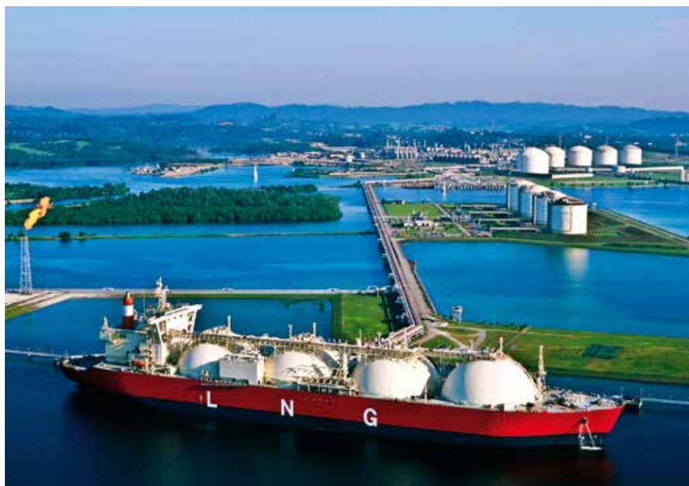
LNG-Tanker mit Kugeltanks: Im flüssigen Zustand kann Erdgas mit Schiffen transportiert werden.
