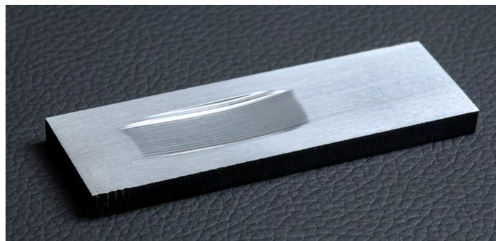
Verschleißprobe nach ASTM G65-Prüfung.
